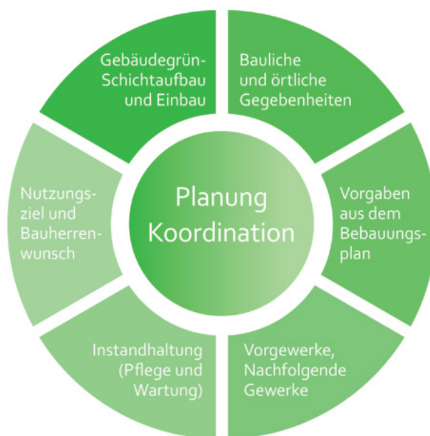
Abb. 4: Beachtenswertes bei der Planung einer Dachbegrünung
